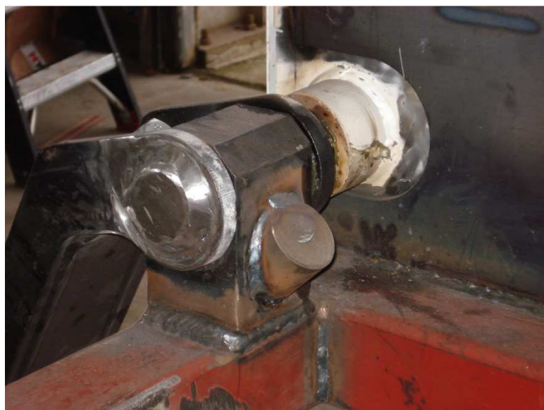
Figuur 3; Lagerblokken 80mm
