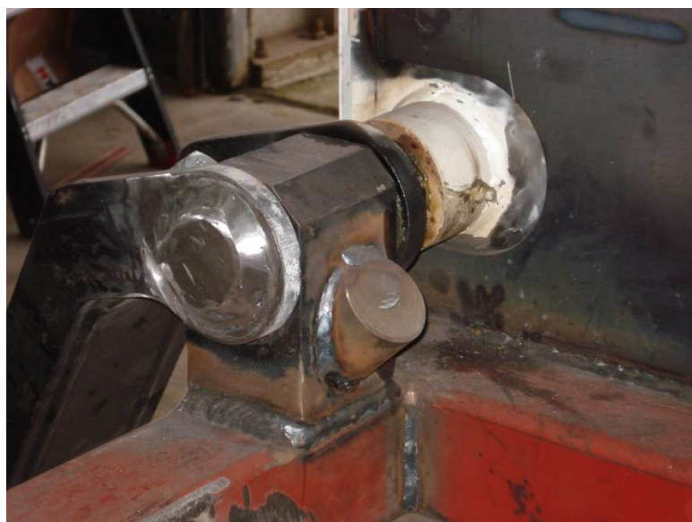
Figuur 11; wig aan lagerblok
