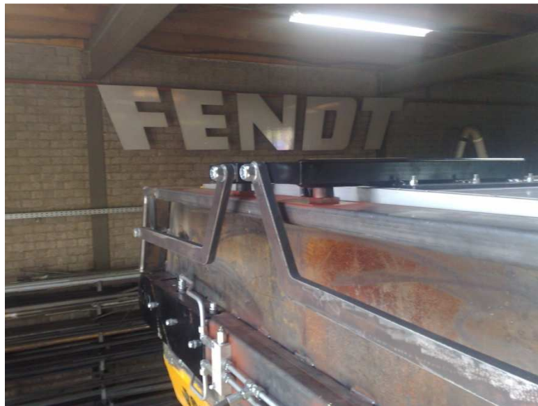
Figuur 10; steun onder stuurarm
